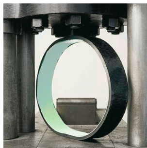
Если труба деформируется, покрытие не повреждается благодаря эластичности полиуретана.
