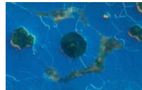
Fonte ductile à graphite sphéroïdal. (image prise au microscope électronique.)
