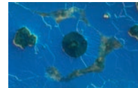
Ghisa duttile con grafite sferoidale. (immagine ripresa con il microscopio elettronico a scansione)
