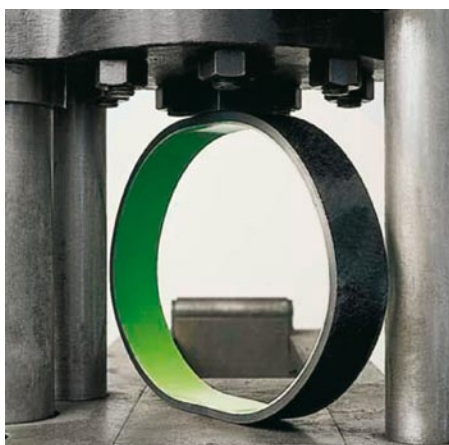
Il rivestimento PUR garantisce un'aderenza perfetta alla superficie in ghisa.
