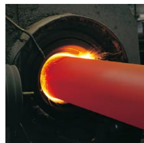
La produzione dei tubi avviene per centrifugazione nei moderni impianti di Choindenz / Svizzera.
