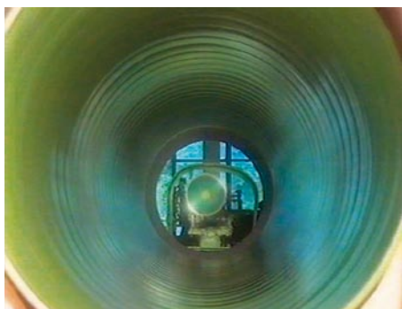
Rivestimento interno automatico in poliuretano (PUR).
